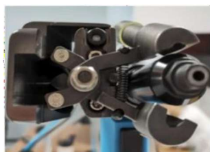
Gruppo di alimentazione anteriore a scomparsa per la massima visibilità operativa.
