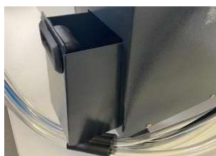
Dispositivo di recupero del chiodo tranciato con stoccaggio automatico nel contenitore interno alla macchina.
