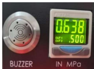
Sensore sonoro di diagnostica che segnala una pressione pneumatica errata o la mancanza del fastener.
