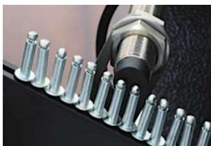
Binario di alimentazione con sensore elettronico per il rilevamento del rivetto in linea.
