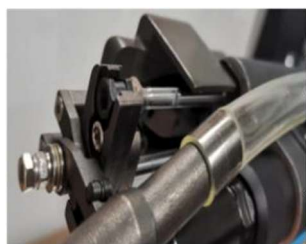
Tubo flessibile per carico rivetti installato a bordo della pistola operatrice
