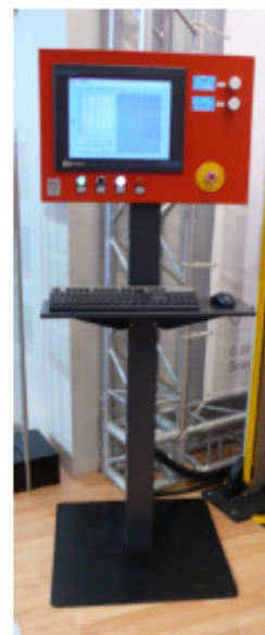
Terminale operativo con PC e software i3 (con convertitore DXF)
