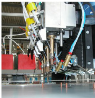
Dispositivo di raffreddamento a spruzzo per la testa automatica
