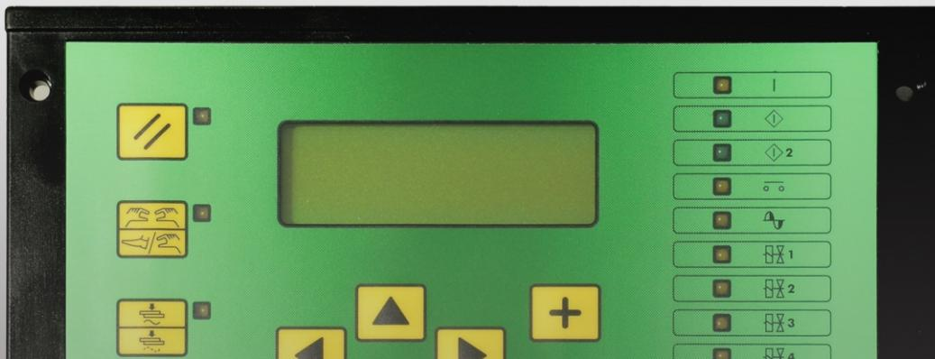
**Il TE550** è un controllo di saldatura a microprocessore per saldatrici a resistenza. La funzione del controllo di saldatura è gestire gli organi della saldatrice, in particolar modo i diodi controllati che eseguono la regolazione della corrente di saldatura.
