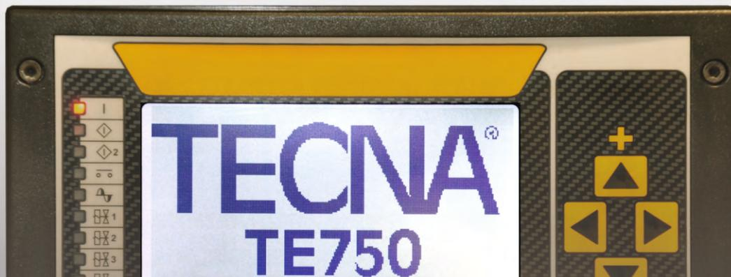
Il **TE750** è un controllo di saldatura a microprocessore per saldatrici a resistenza con tecnologia inverter. La funzione del controllo di saldatura è gestire gli organi della saldatrice, in particolar modo il gruppo di potenza a IGBT che effettua la regolazione della corrente di saldatura.
