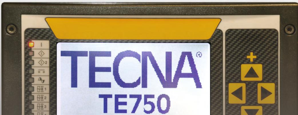
Le **TE750** est un contrôle de soudure à microprocesseur pour soudeuses à résistance avec technologie "inverter". La fonction du contrôle est de gérer les organes de la soudeuse, en particulier le module de puissance à IGBT qui assure le réglage du courant de soudage.
