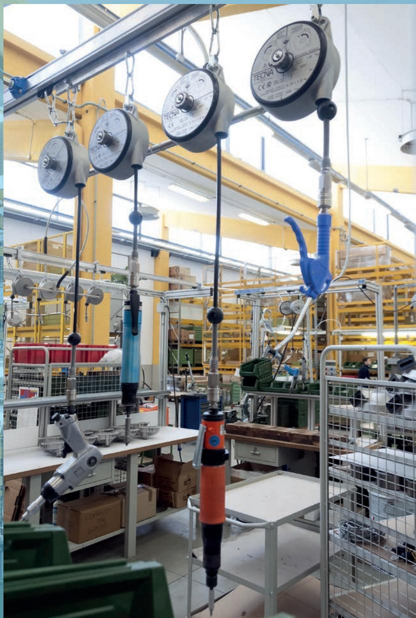
TECNA propone una linea completa di **BILANCIATORI PER TUBI PNEUMATICI** e **ACCESSORI PER TUBI PNEUMATICI**, perfetti per bilanciare e lavorare in modo ergonomico con gli utensili pneumatici.
