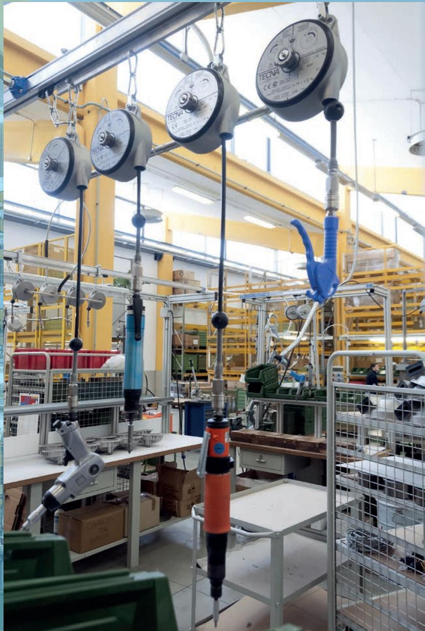
TECNA bietet ein komplettes Sortiment an AIR HOSE Federzügen und AIR HOSE SPIRAL ACCESSOIRES an, die perfekt für das Ausbalancieren und ergonomische Arbeiten mit Druckluft-WERKZEUGEN sind.
