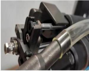
Tubo di alimentazione rivetto posizionato sulla pistola di rivettatura
