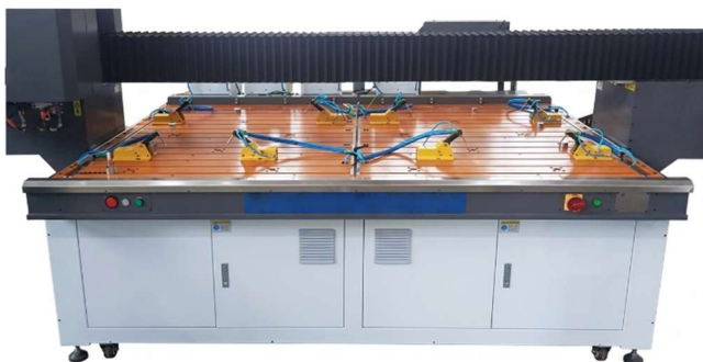
Piano di lavoro modulare con sfere portanti a scomparsa.
