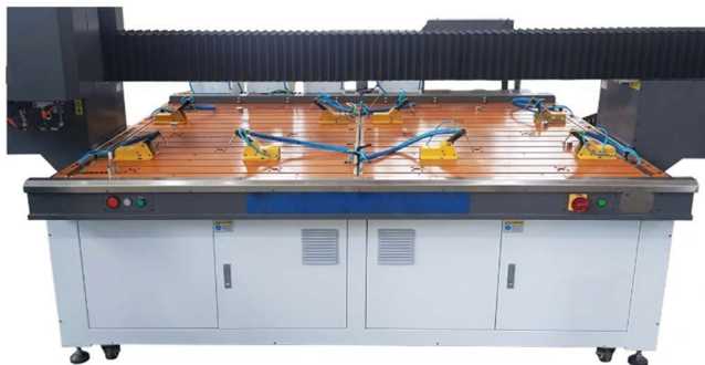
Modulare Arbeitsplatte mit versteckten tragenden Kugeln.
